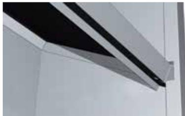
Прикрепить среднюю полку к задней стенке с помощью саморезов.
